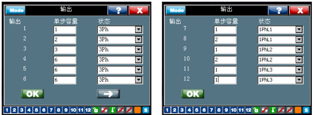
图 31: 典型输出端设置 6 x 3ph + 6 x 1ph (RVT12-3P 三相型号)
